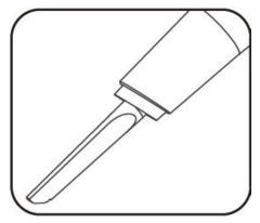
1. Всасывающая насадка: подходит для очистки дверей, сидений, углов шкафов, ящиков и пепельниц.
