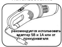
1. Подключите зарядное устройство для полной зарядки аккумулятора (индикатор во время зарядки красный; при полной зарядке индикатор зарядки синий).
