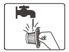
3. При необходимости очистите пылесборник влажной тканью или одноразовым бумажным полотенцем. Сетку фильтра можно мыть водой. После промывания его необходимо полностью высушить, а затем можно использовать снова.
