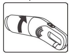
1. Поверните пылесборник против часовой стрелки, чтобы снять его с пылесоса.
